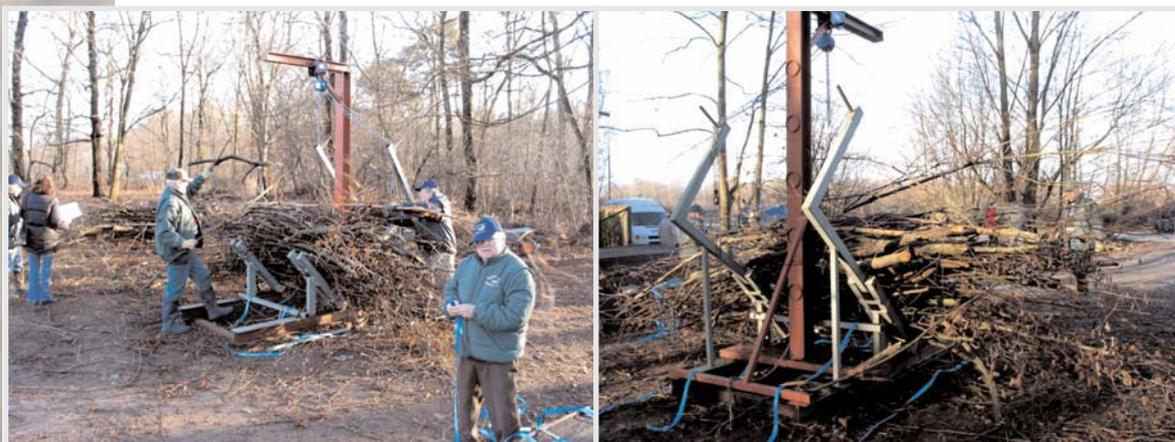
Das Astmaterial wurde von freiwilligen Helfern zusammengetragen und in einer eigens für diesen Zweck konstruierten “Totholzpressen” gebündelt.
