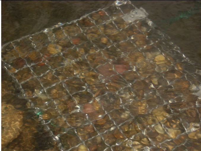
Vollständig mit Kies aufgefüllter Drahtkorb mit 5 Stück vergrabenen WV-Boxen.
